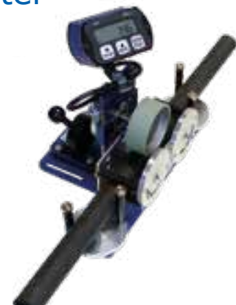
WF58-RM-50 Winkelflansch / spielkompensiert Messbereich bis zu 50 x 50 mm
