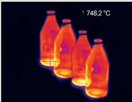
Hot-Spot-Messung bei der Herstellung von Glasflaschen
