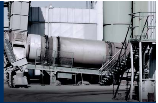
Anwendungsbeispiel: Drehrohren in der Chemieindustrie
