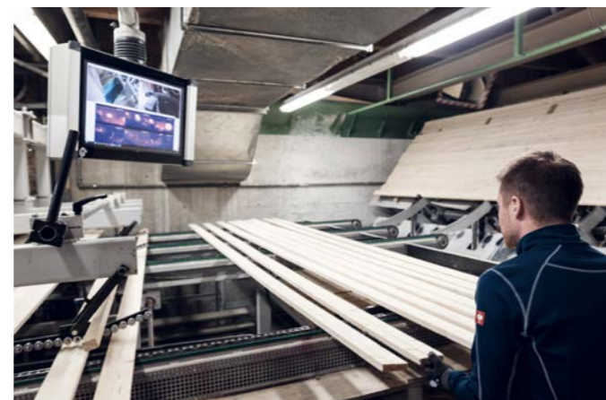
Die Software PIX Connect ermöglicht die Überwachung von Hobelanlagen. Bild: binderholz
