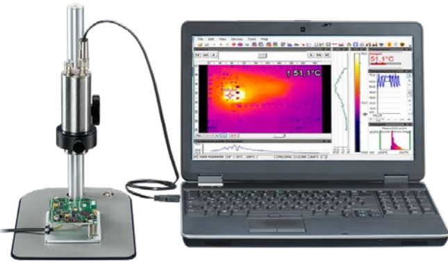
Mikroskopoptik Xi 400 für die Analyse kleinster Komponenten
