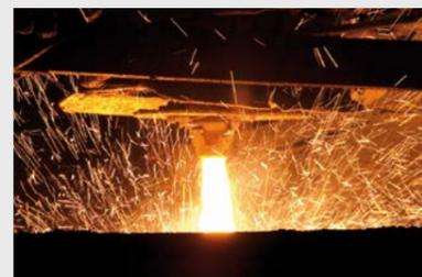
Gießstrahlmessung während des Abgusses in eine Form
