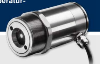
Die **Infrarot-Thermometer** optris CTlaser 05M / 1M / 2M / 3M wurden speziell zur **Temperaturmessung an Metalloberflächen und flüssigen Metallen** entwickelt. Sie zeichnen sich durch kurzwellige Spektralbereiche von 525 nm (05M), 1 µm (1M), 1,6 µm (2M) und 2,3 µm (3M) aus, die auch Messfehler bei Emissionsgradveränderungen minimieren. Der Temperaturbereiche der Thermometer liegen zwischen 50 °C und 2200 °C.
