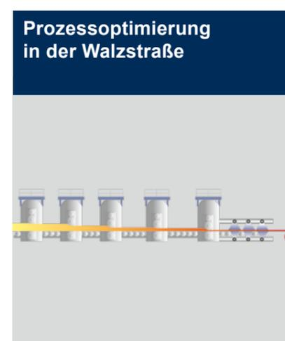
**Aufgabe:** Bei der Herstellung von Halbzeugen werden die Brammen im Gerüst von ca. 1250 °C heruntergekühlt. Zur Sicherstellung der Qualität und zur Prozessoptimierung wird die Umformtemperatur zwischen den einzelnen Walzen gemessen.
