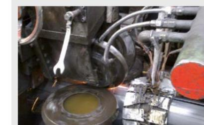
Temperaturüberwachung der Rohrränder kurz vor dem Verschweißprozess
