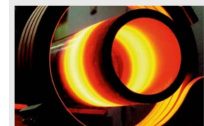
Induktiv erwärmtes Rohr
