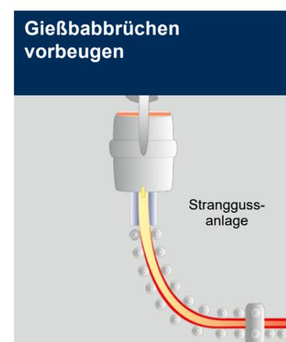
**Aufgabe:** Mit wachsender Effizienz steigt auch die Beanspruchung von Stranggießanlagen. Das erfordert umfangreiche Prozessüberwachungsmaßnahmen, besonders bei der Temperaturmessung: die Technik ist bei höherer Genauigkeit günstiger geworden. Für die Betreiber lohnt sich die Investition, denn so kann kostenintensiven Gießabbrüchen schon in der Entstehung vorgebeugt werden.
