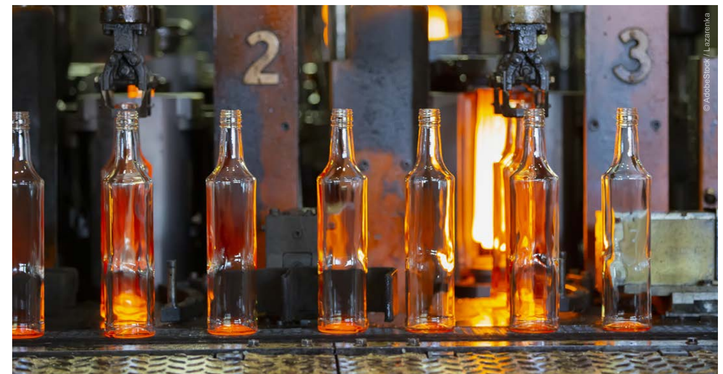
Temperaturmessung zur Qualitätskontrolle nach dem Formgebungsprozess
