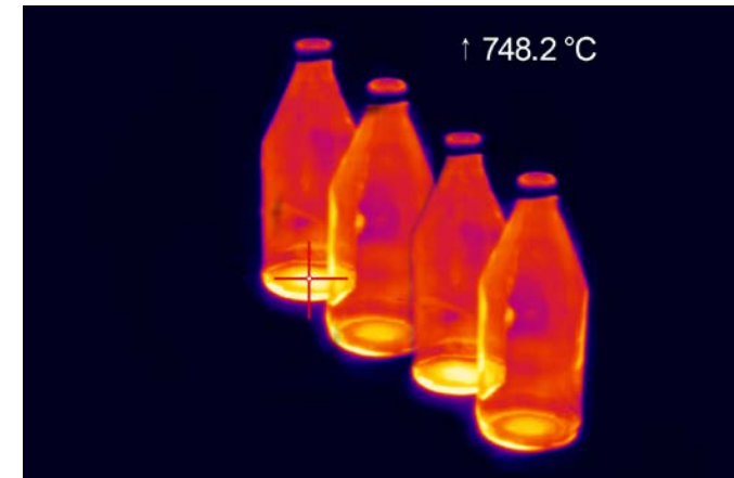
Hot-Spot-Messung bei der Herstellung von Glasflaschen
