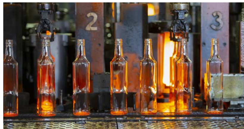
Temperaturmessung zur Qualitätskontrolle nach dem Umformprozess
