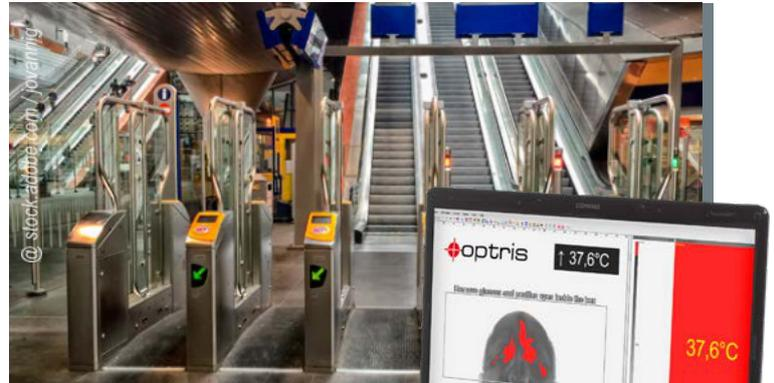
Diese Methode wird vor allem an Kontrolltoren oder dort eingesetzt, wo eine Gruppenkontrolle nicht möglich ist. Aus geringerer Entfernung kann die Temperatur des Medial Canthus (Tränenkanal) exakt gemessen werden, der die stärkste Korrelation zwischen der Außenhauttemperatur und der Körperkerntemperatur aufweist. Mit dieser Methode können auch niedrigere Fiebergrade nachgewiesen werden.
