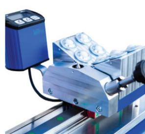
Halterung zur Aufnahme von Rohren - Kugeln erlauben unterschiedliche Durchmesser
