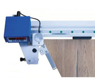
Lösung zur Winkelmessung von Profilen, Rohren oder Platten.
